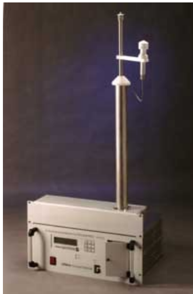
Obrázek 14: Analyzátor Grimm využívající optoelektronickou metodu [48]
