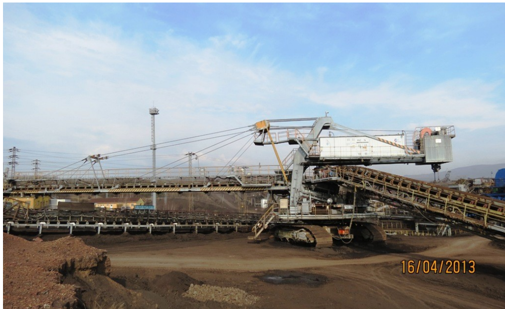
Obrázek č.2 – Pásový vůz zakládací PVZ 2500/14 (Tomáš Talacko)
