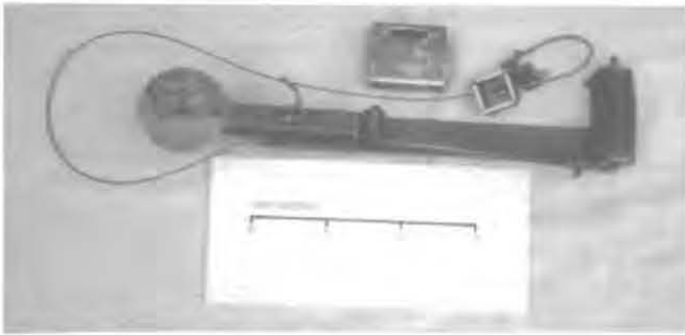
Fig. 3.24. Novak foot snare. Photo by G. F. Hubert, Jr.
