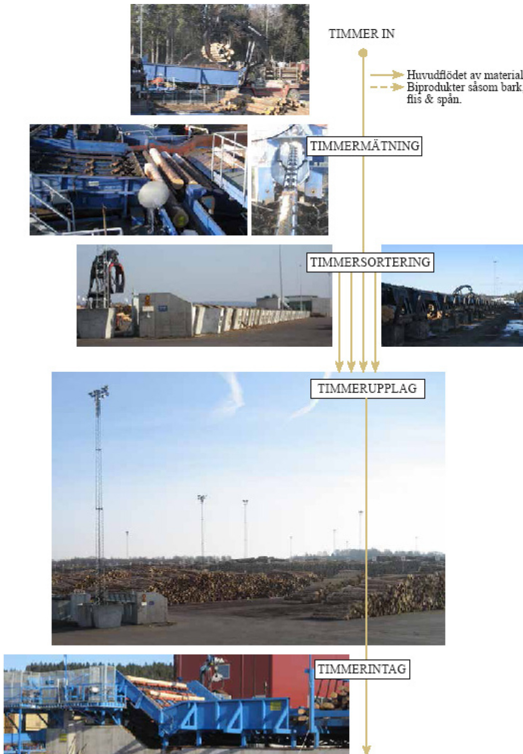
Figur 3. Principskiss som visar sågverksprocessen (Foto: Carl af Ekenstam 2013).
