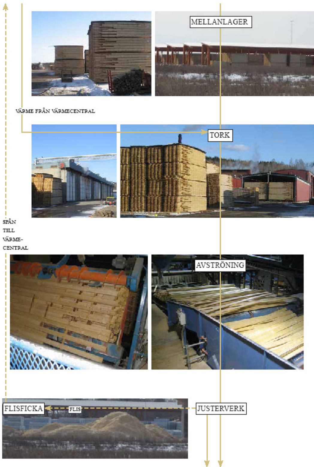
Figur 5. Principskiss som visar sågverksprocessen (Foto: Carl af Ekenstam 2013).
