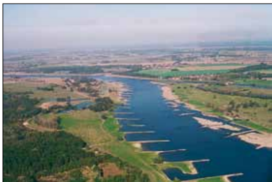
Abb. 1: Die Elbe ist in ihrem gesamten Mittellauf mit ca. 6.900 Buhnen ausgebaut, hier Elbe bei Schönberg Deich/Altmark. Foto: O. Büttner (UFZ).
