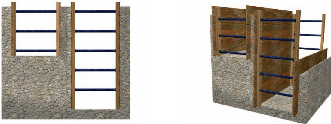
Figura 2 - Esempio di posizionamento di armatura in fasi parziali e successive di scavo
