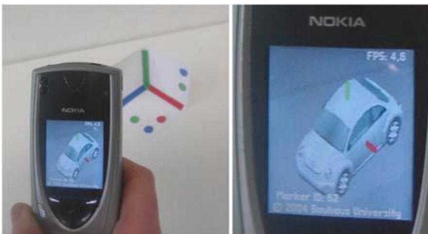
Figura 2.7 - Exemplo de um ecrã do tipo *Hand-Held Video See-Through* [22].
