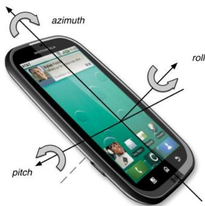
Figura 2.8 - Representação dos três ângulos para orientação [26].
