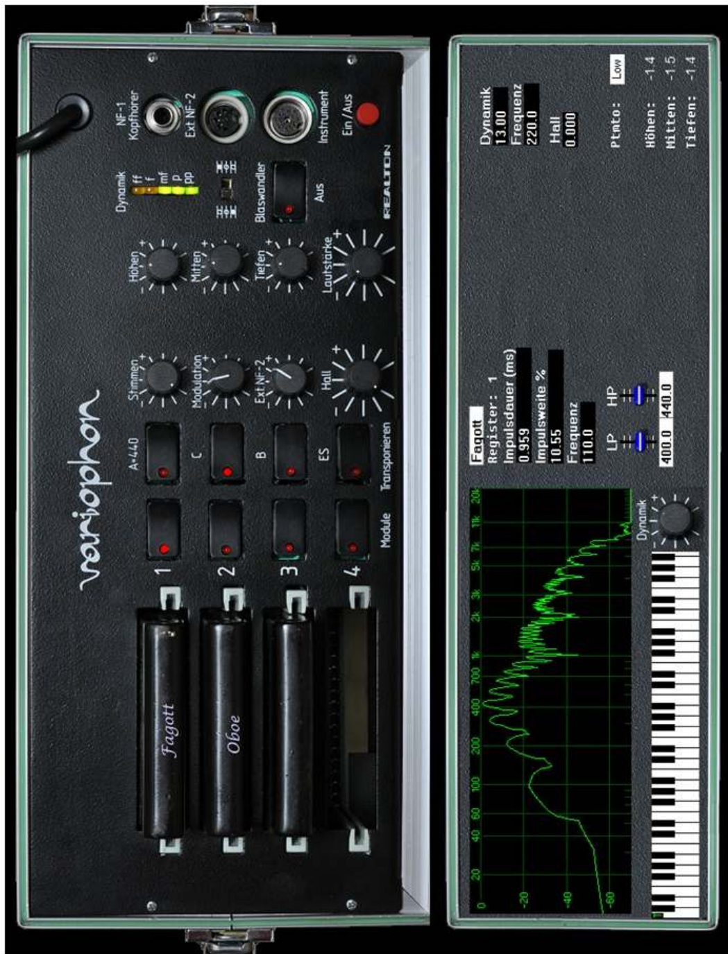
Abb. 4.21. Das GUI des SynthEdit-Variophon. Im oberen Teil entspricht es dem Variophon Spot. Drehknöpfe, Tasten und Tastatur lassen sich mit der Maus bedienen. Die Drehknöpfe drehen synchron mit den Knöpfen der MIDI-Tastatur. Im unteren Teil finden sich zusätzliche Anzeigen, die es am analogen Variophon nicht gibt: Dynamik-Stufe, Frequenzen, Impulsdauer, Impulsweite, EQ-Filter-Werte, Nachhall und Portamento-Einstellung sowie ein Frequenzanalysator. Die Anzeigen für Register, Impulsdauer, Impulsweite, Frequenz (des Instrumentes), LP (Low Pass) und HP (High Pass) werden nur für jeweils aktive Module (in der Abbildung für das Fagott) angezeigt.
