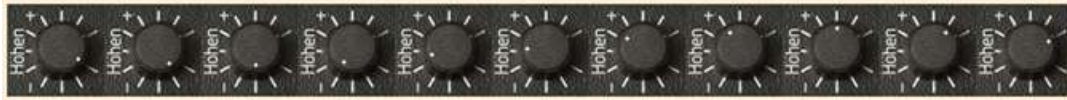
Abb. 4.19. Das Grafikfile zur Darstellung des Höhenreglers. Pro Regelstellung wird ein Bild benötigt. SynthEdit wählt das zu jeder Regelstellung (die mit Maus oder extern über MIDI verändert wird) korrespondierende Bild innerhalb der Grafik aus und bringt es zur Anzeige auf dem GUI.
