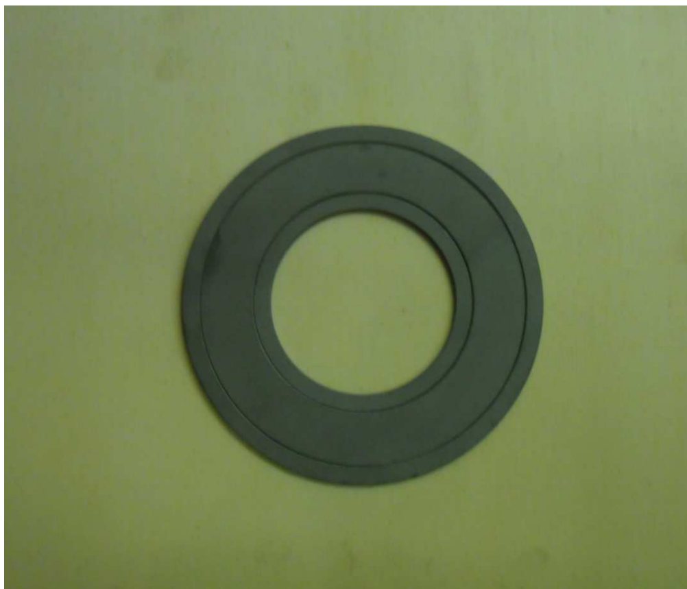
Fig. 3.2 – Provini toroidali ottenuti dalla stessa lamina di acciaio Fe-9Cr
