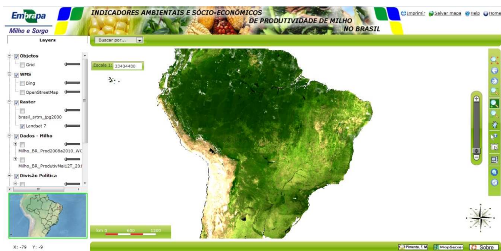
Fig. 6.9. Visualização no servidor de mapas da camada apresentando o mosaico de imagens obtidas pelo satélite Landsat 7 ETM+/NASA entre 1999 e 2002.
