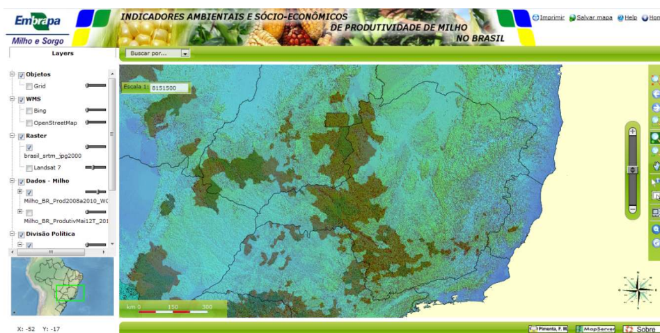
Fig. 6.24. Alteração do nível de opacidade (transparência) entre camadas de informação sobrepostas no servidor de mapas: camada superior com transparência, permitindo a visualização de feições da(s) camada(s) inferiores. No exemplo, foram sobrepostos dois mapas temáticos: o inferior, representando a variação de relevo (imagens SRTM ), e o superior, a produção média de milho por município entre 2008-2010 (mais detalhes sobre os mapas temáticos considerados neste trabalho encontram-se no Capítulo V ).
