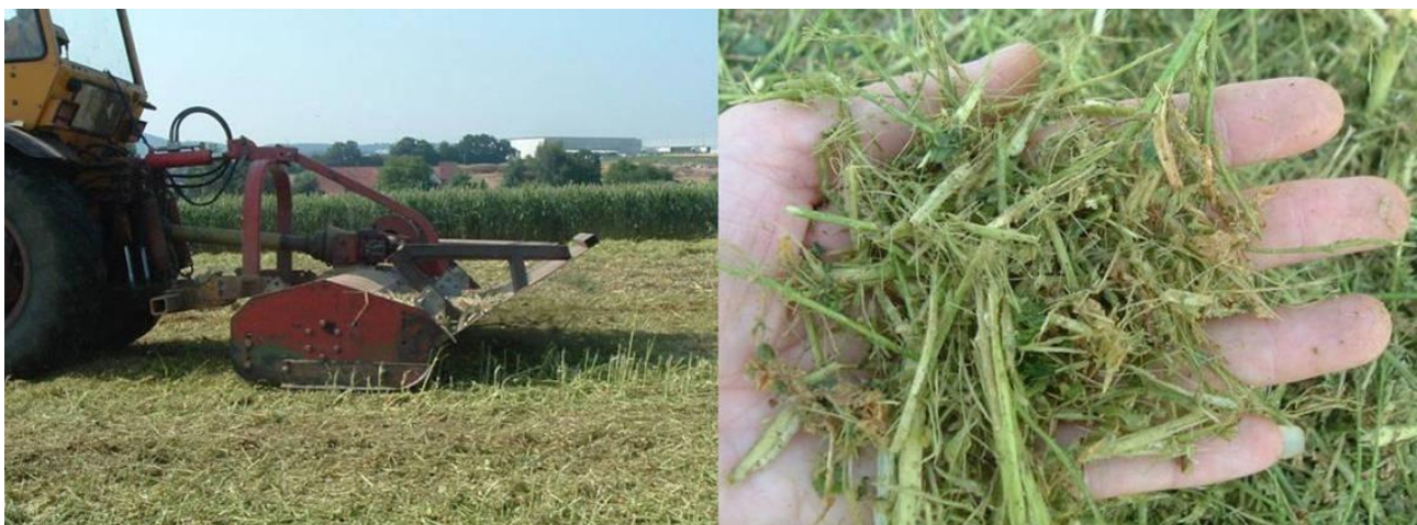
Abbildung 32: Verticillium , Versuchsstandort 3, 2010: Standort IIsfeld: Zerkleinerung von Brassica juncea mit dem Schlegelmulcher im Frontanbau durch eine zweimalige Überfahrt.
