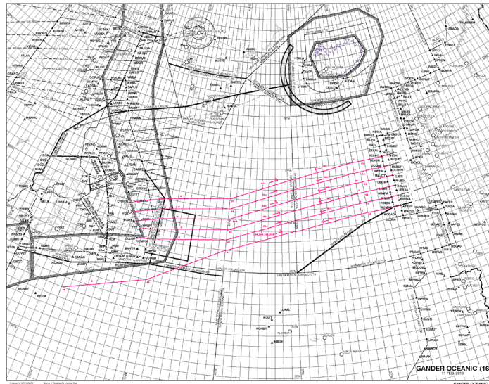
Abbildung 2.4: Exemplarisch für einen bestimmten Tag vorgegebene Routen für ostwärts gehende Flüge im NMPA. Quelle: (ICAO 2011)
