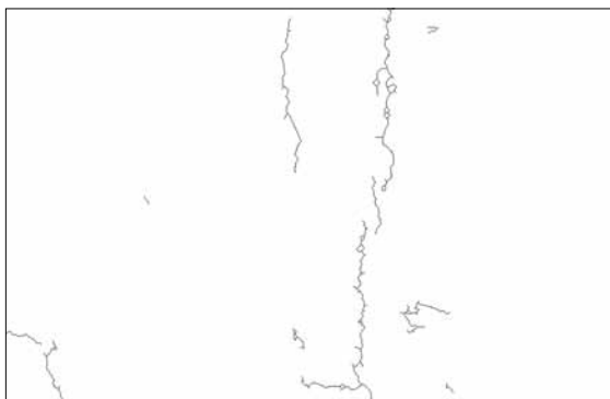
Fig. 15 Esqueleto de las grietas de una imagen
