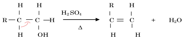
Fig. 14. Reacción de obtención del eteno.
