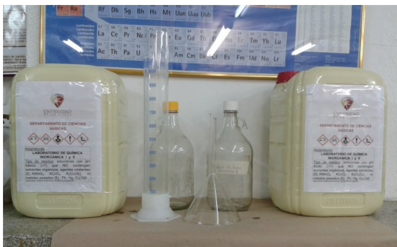
Fig. 23. Recipientes para almacenar los RESPEL del laboratorio de química de la CUC.
