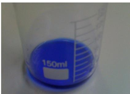
**Fig. 14. Precipitado de tetramindihidroxido de cobre II.
