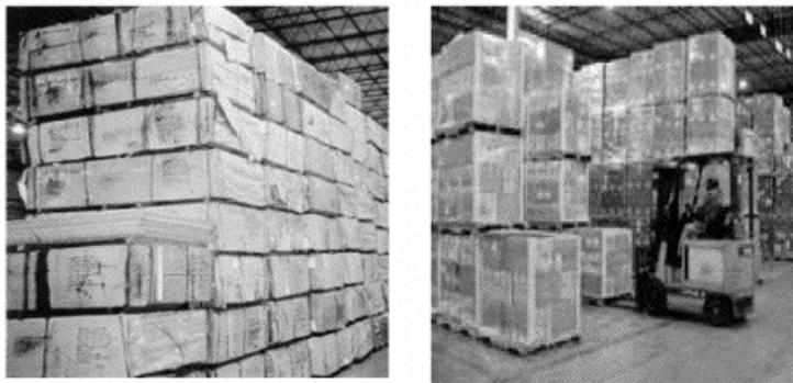
*Figura 7. Ejemplo de almacenamiento en bloques. Fuente:www.wikipedia.com*
