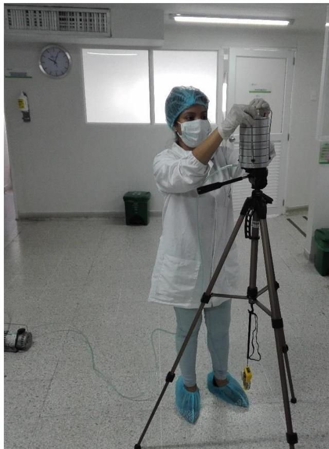
**b.** Instalación del impactador de cascada de seis etapas
