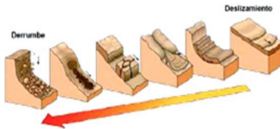
Figura 1.3. Maqueta de los distintos tipos de transformaciones de pendientes por procesos de deslizamiento y derrumbe,
