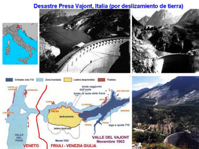
Figura 1.4. Desastre de la presa Vajont al norte de Italia. Mapa de localización, imágenes iniciales de la presa y luego del deslizamiento.
