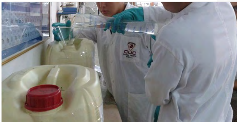
Figura 17. Envasado de los RESPEL en los tanques para sustancias inorgánicas sin metales pesados ni agentes redox.
