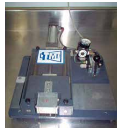
Figura 5.4. Cortadora neumática (ECT) (Laboratorio Cenpack)
