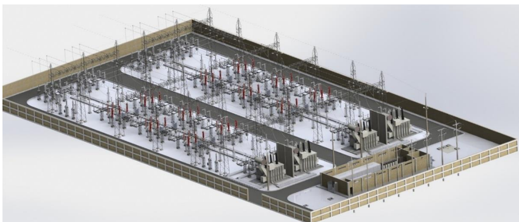
Figura No 8. Subestación doble barra con equipo compacto en SF6
