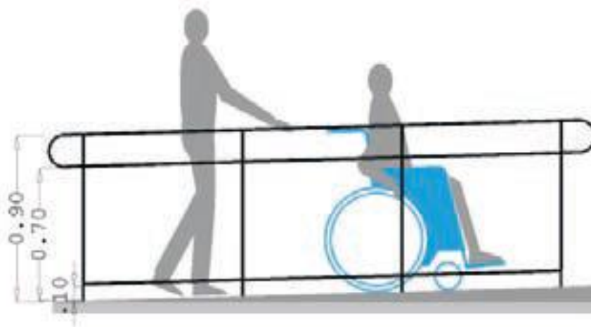
Figura 41. Dimensionamiento de barandas (Fuente: Fundación Once. Manual de Accesibilidad para técnicos municipales, Feb. 2011)
