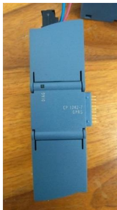
Figura 28 Modulo CP1242 GPRS marca Siemens
