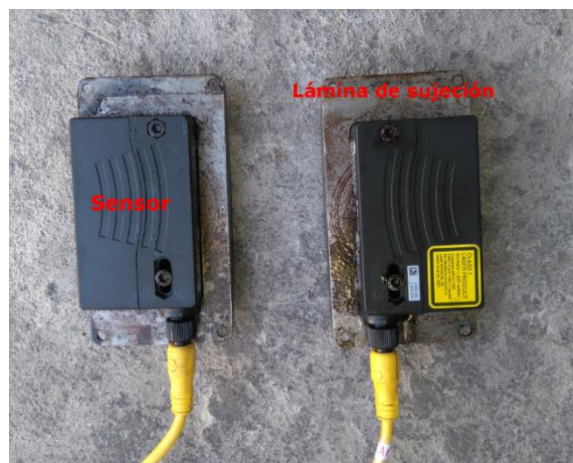
Figura 32 Sensores de proximidad y lámina de sujeción.
