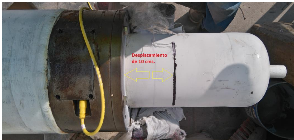
Figura 51 Marca de desplazamiento del tubo de extensión 1.
