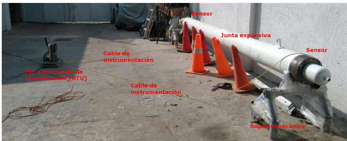
Figura 35 Disposición de los equipos para la prueba del sistema de monitoreo.
