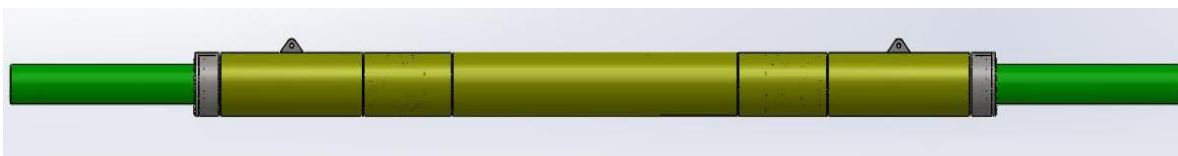
Figura 1 Estructura básica de la junta expansiva.
