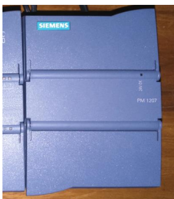
Figura 26 Fuente SIMATIC PM1207 Siemens
