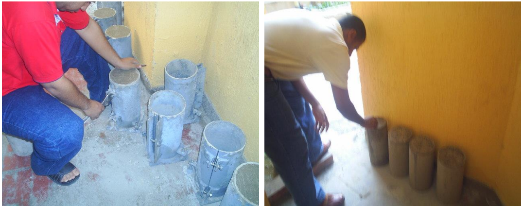
Figura 16. Desencofrado y marcación de cilindros de concreto de 15x30 cm.
