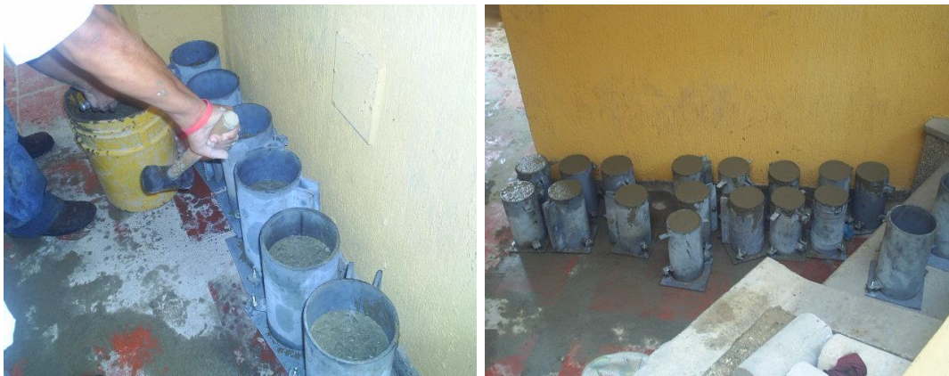
Figura 15. Desalojo de aire del concreto con mazo de caucho, izquierda, y moldes totalmente llenos.
