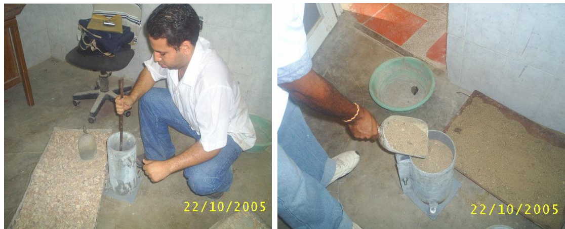
Figura 11. Realización del ensayo de masa unitaria compacta de agregado grueso, izquierda, y masa unitaria suelta, derecha.
