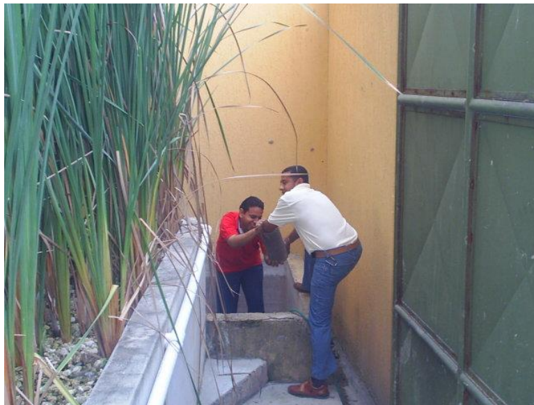
Figura 17. Colocación de cilindros de concreto de 15x30 cm en piscina de curado.
