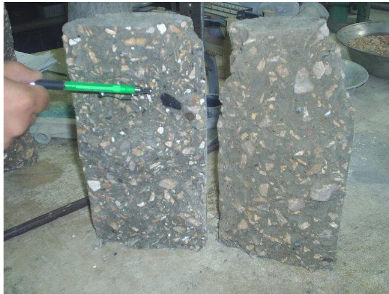
Figura 23. Cilindro de concreto de 15x30 cm con trazos de materia orgánica.
