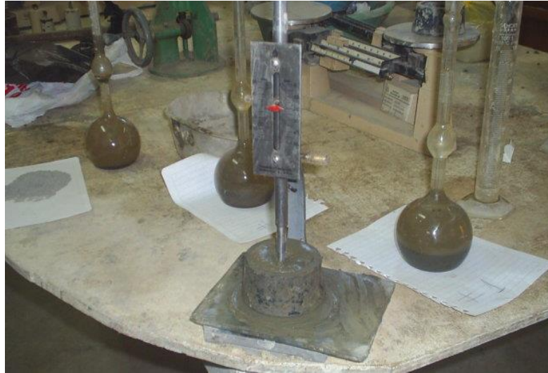
Figura 10. Aparato de Vicat penetrando en la pasta de cemento.
