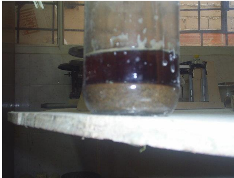
Figura 19. Resultado del ensayo de materia orgánica al agregado fino.
