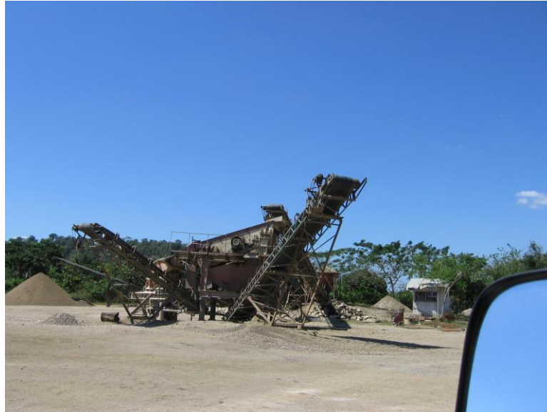
Figura 5. Trituradora de agregado grueso de Toluvejo.
