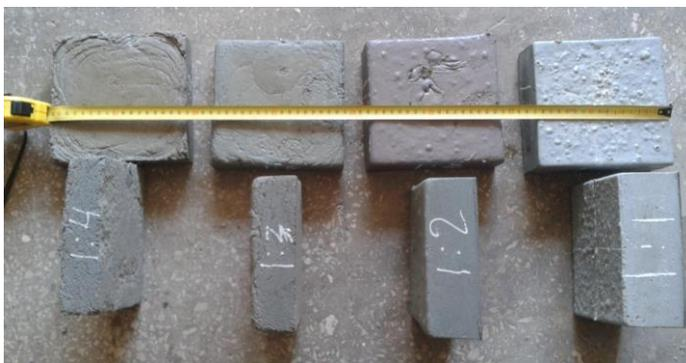
Рис. 2. Внешний вид блоков ТПКМ
