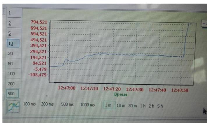
Рис. 9. Температура и время нагрева ТПКМ напротив четвертой трещины с раскрытием 30 мм
