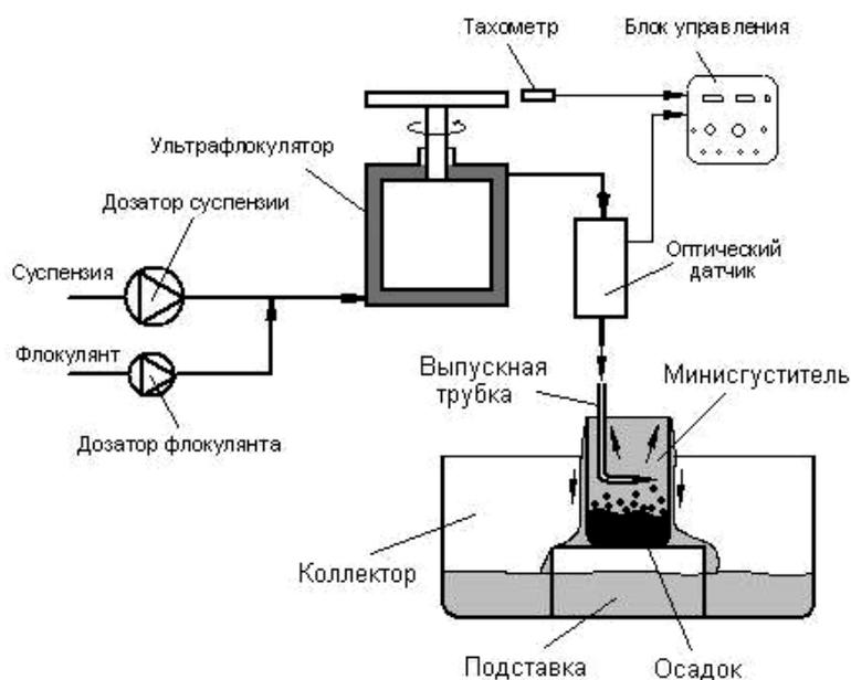
Рис. 1. Схема лабораторной обработки образцов питания сгустителя
