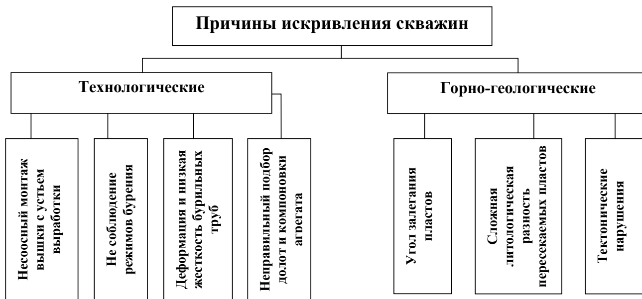
Рис. 5. Основные причины и факторы, вызывающие искривление стволов при бурении
