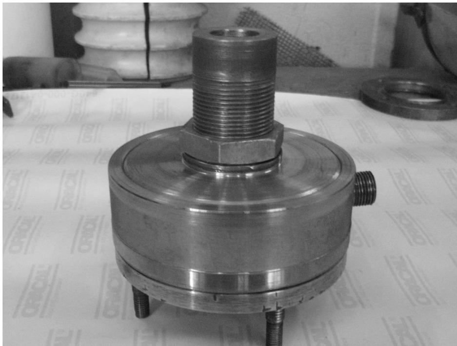
Рис. 2. Общий вид осесимметричной модели эжектора струйной мельницы
