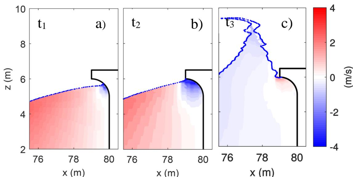
**Figure 2.** Evoluzione temporale della superficie libera e del campo di velocità orizzontale sulla parete del muro ricurvo: a) istante  $t_1$ , b) istante  $t_2$ , c) istante  $t_3$ . Gli istanti  $t_1$ ,  $t_2$  e  $t_3$  coincidono con quelli riportati nel pannello di destra della Figura 1.
