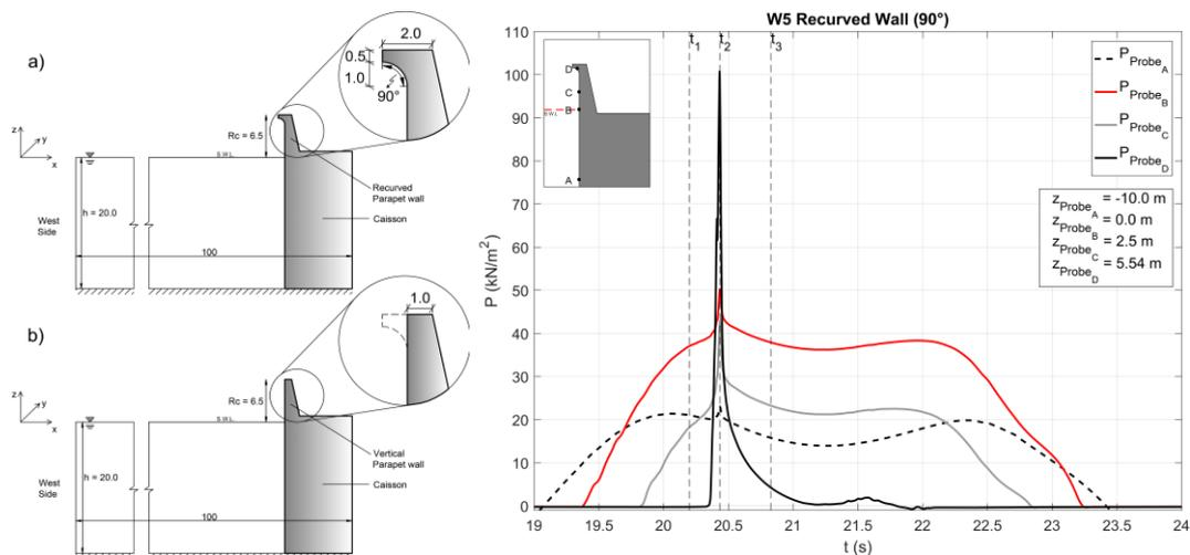
**Figure 1.** Pannello di sinistra: schema delle due geometrie simulate numericamente. Pannello a) muro ricurvo. Pannello b) muro verticale. Le quote nella figura sono in metri. Pannello di destra: serie temporali delle pressioni impulsive registrate da quattro sonde poste lungo il muro ricurvo poste sia al di sopra sia al di sotto del livello medio marino.
