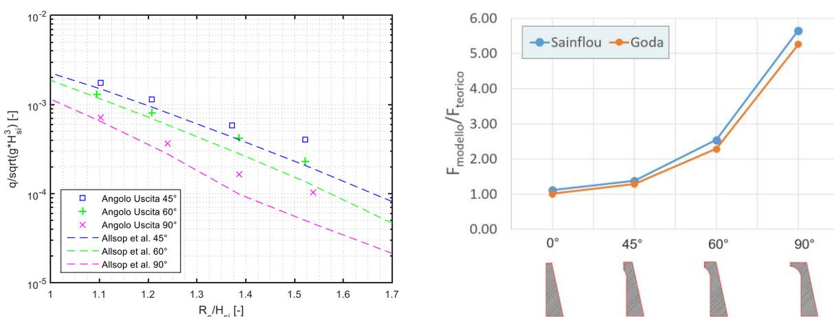
**Figure 4.** Pannello di sinistra: andamento della portata di tracimazione adimensionale in funzione del rapporto  $R_c/H_{si}$ . Pannello di destra: forze agenti sul parapetto rapportate a quelle previste da Goda al variare del settore di circonferenza che costituisce la parte ricurva del muro.
