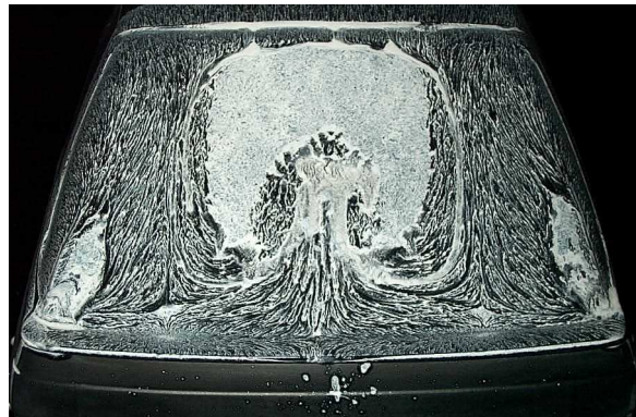
Figure 1 : Visualisation du frottement pariétal sur la lunette arrière d'une automobile.
