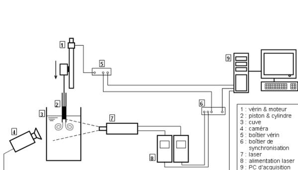
Figure 4 - Montage expérimental
