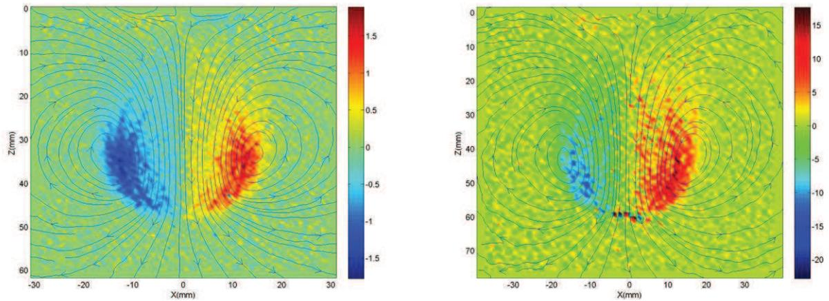
Figure 7 – Champs de vorticité instantanés à  $t^*=4.6$  calculé par intercorrélation sur GPU. (à gauche pour l’anneau tourbillonnaire se développant dans de l’eau, à droite dans une solution de Xanthane X4)
