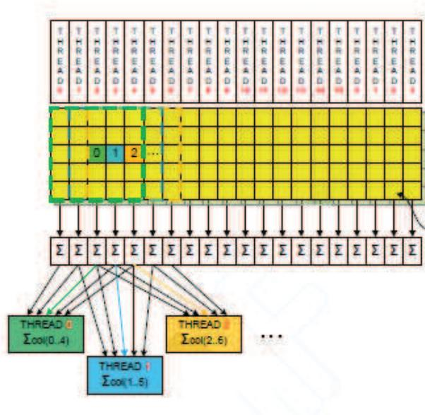
Figure 3 – Schéma de calcul du terme  $\overline{I1_{u,v}}$
