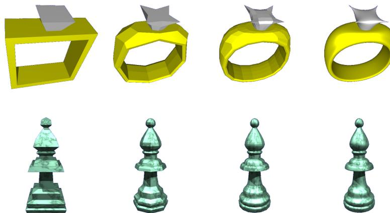
**Figura 1:** Alcuni esempi di applicazione degli schemi di suddivisione: da un oggetto iniziale rappresentato in maniera "grezza" si riesce ad ottenere una rappresentazione più "fine" dello stesso oggetto.
