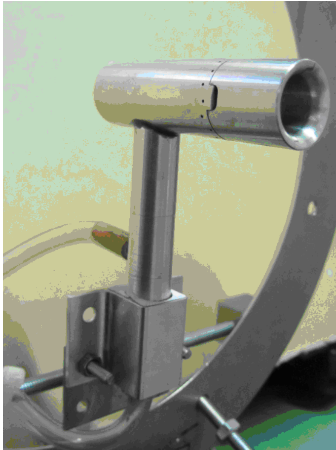
Figura 4.28: Sonda di velocità montata sul supporto gimbal.
