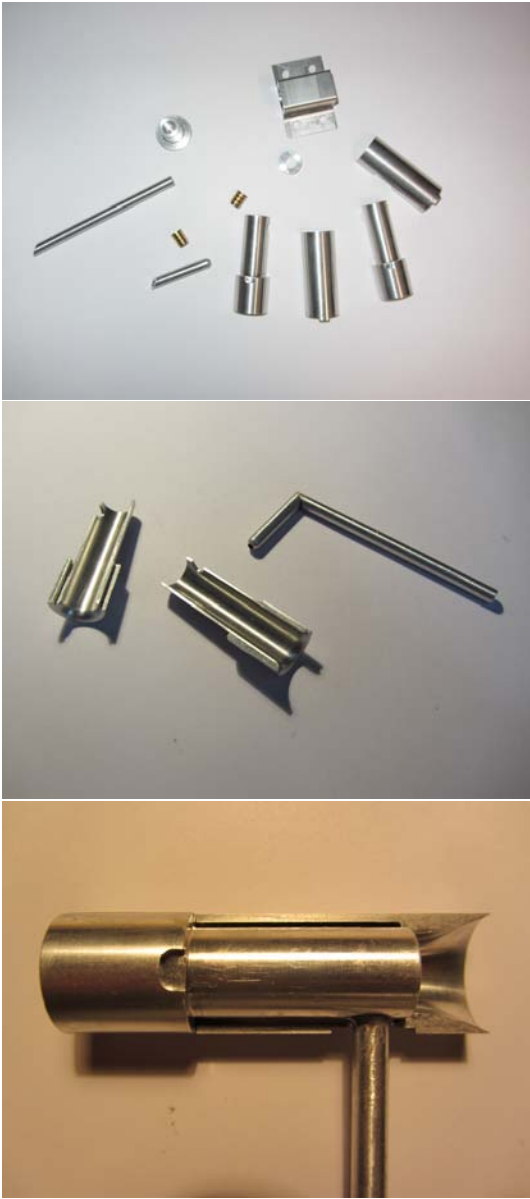
Figura 4.27: Fasi dell'assemblaggio della sonda di velocità.
