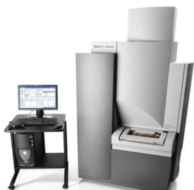
Figura 8 – MALDI ( Matrix Assisted Laser Desorption Ionization ) consiste num método de ionização, que utiliza uma fonte de luz laser que incide sobre uma matriz cristalizada composta pela amostra e por pequenas moléculas orgânicas.
