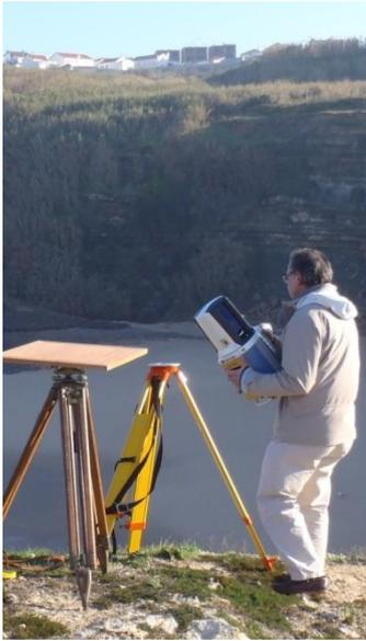
**Fotografia 12 - Montagem do LS em cima de tripé e mesa de apoio na praia dos Coxos.**
