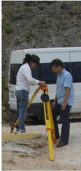
**Fotografia 13 - Nivelamento para colocação do prisma que serve de ponto de referência na praia dos Coxos.**
