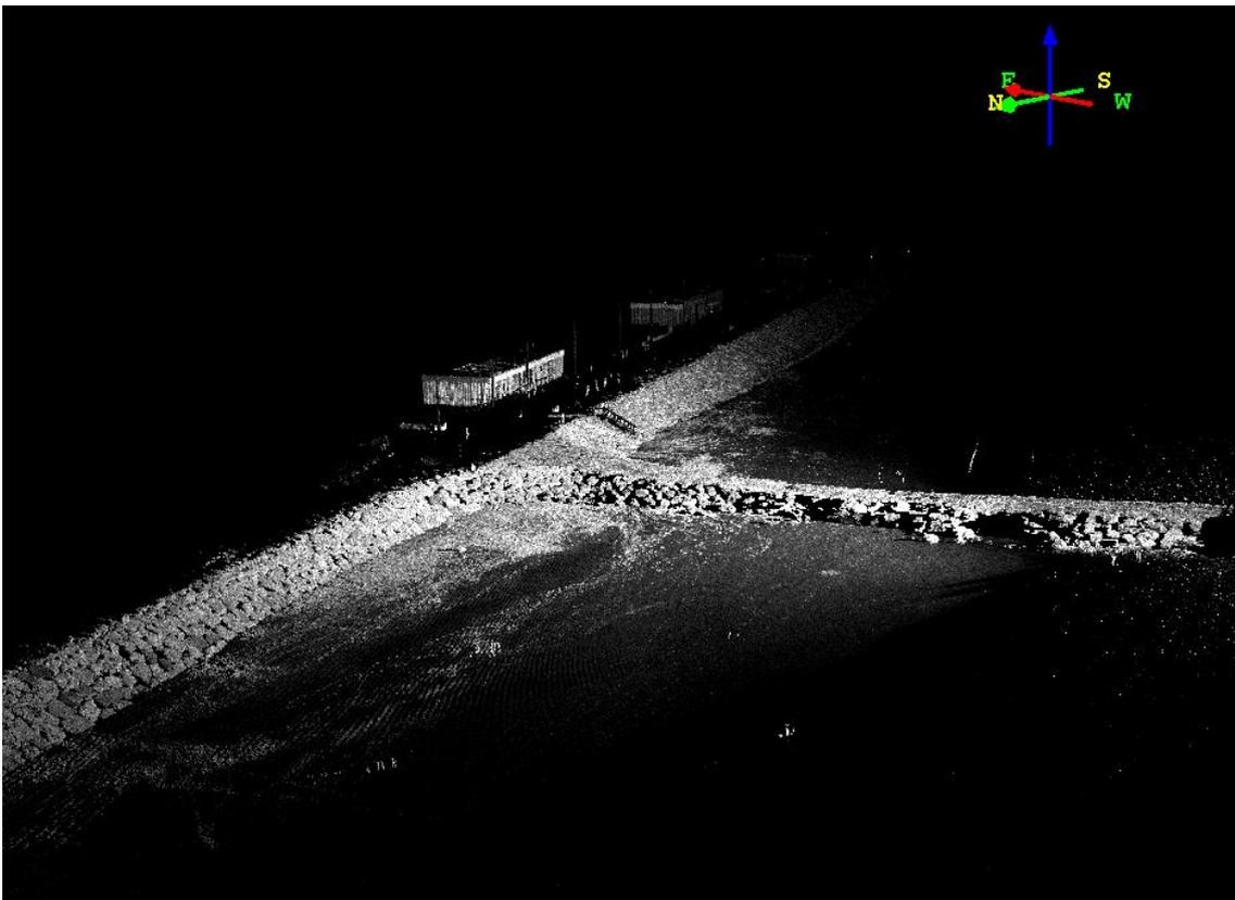
Figura 15 - Nuvem de pontos e intensidade. Levantamento de Março 2012 da praia de São João (esporão do limite sul), aplicação QTM.
