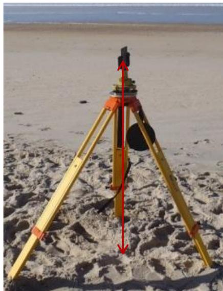
**Fotografia 16 - A vermelho, altura medida para aferição da cota do prisma que serve de ponto de referência na praia de P. da Vitória.**
