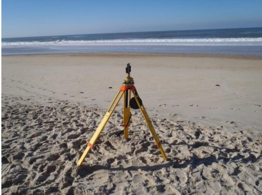
**Fotografia 18 – Praia de Paredes da Vitória. Pormenor do local de posicionamento do prisma e do LS para as estações E1 e E2 respectivamente. Evidência da marca do último espraio de preia-mar através do pisoteio.**
