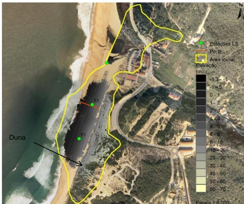
**Figura 60 – Praia de Paredes da Vitória. Limite da área levantada, localização das estações LS, perfil P1 e MDS.**
