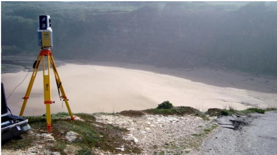
**Fotografia 11 – LiDAR terrestre instalado para efectuar o levantamento topográfico do areal de praia e arriba (praia dos Coxos).**
