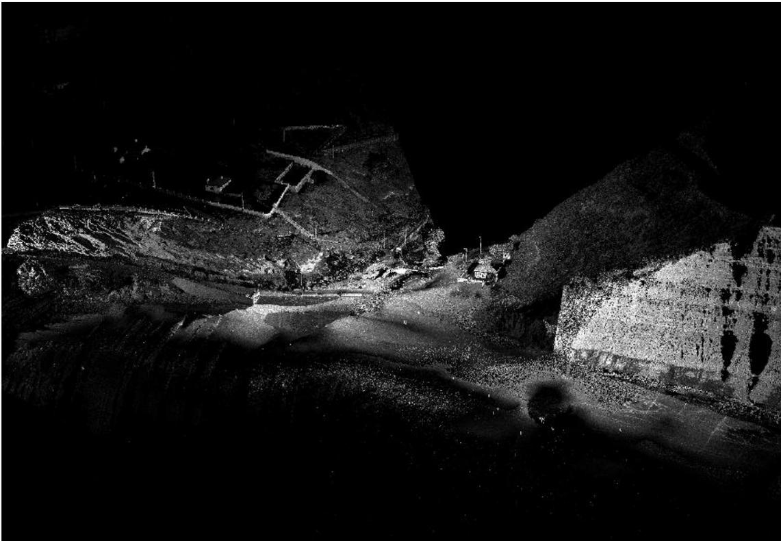
**Figura 13 - Nuvem de pontos e intensidade. Levantamentos de Dezembro 2011 e Janeiro 2012 da praia do Magoito (areal e arriba), aplicação QTM.**
