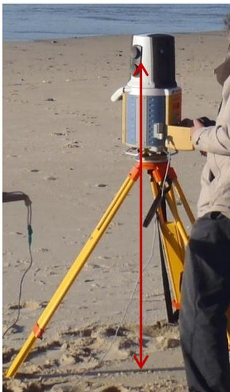
**Fotografia 15 - A vermelho, altura medida para aferição da cota do LS na praia de P. da Vitória.**
