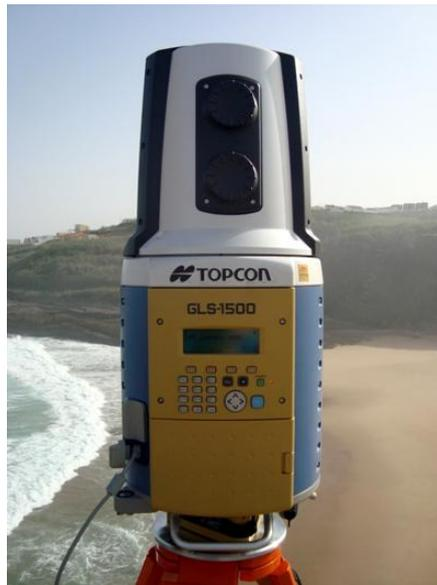
**Fotografia 1 - LiDAR terrestre (TOPCON GLS 1500 - modelo utilizado neste trabalho).**
