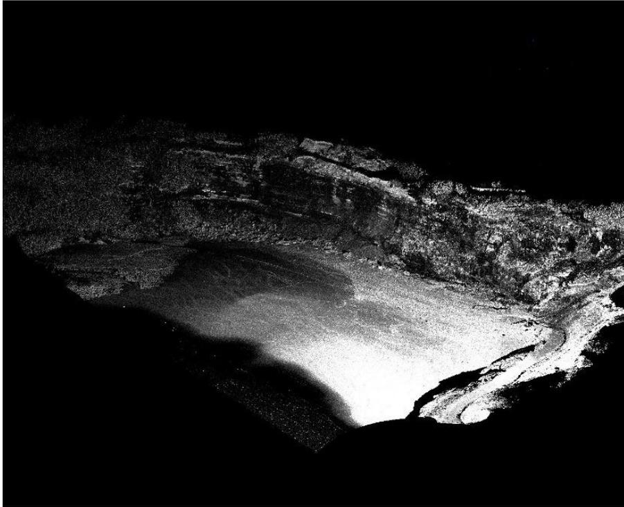
**Figura 12 – Nuvem de pontos e intensidade. Levantamento de Dezembro 2011 da praia dos Coxos (areal e arriba), aplicação QTM.**
