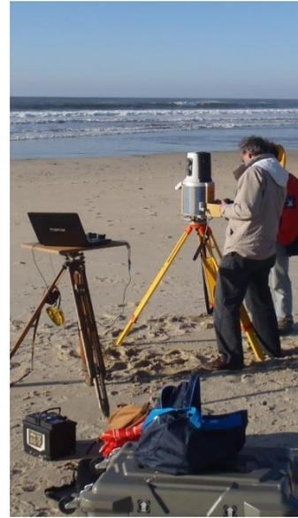
**Fotografia 14 - LS em cima de tripé, computador e bateria na praia de P. da Vitória.**
