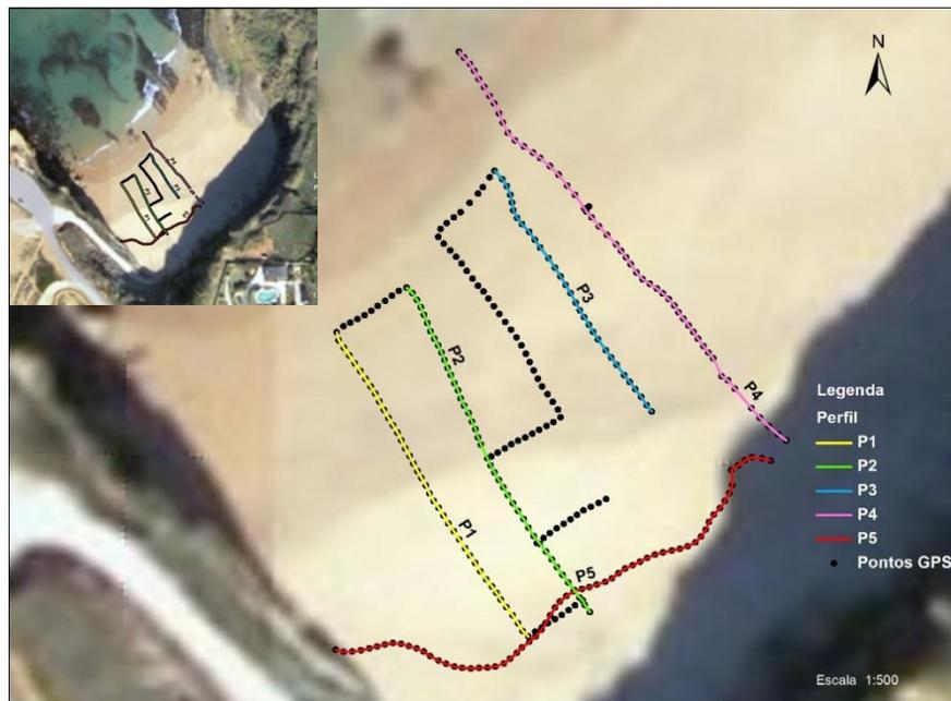
**Figura 22 – Localização geral e de pormenor dos pontos adquiridos com recurso ao GPS-RTK e dos perfis topográficos realizados.**
