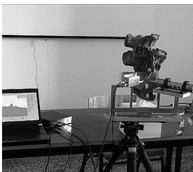
Fig. 21 - Composição elementar através de fluorescência raio X
