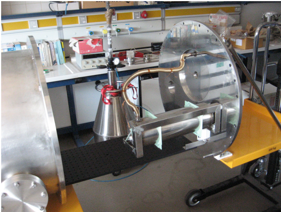
Figura 4.33: Imagem evidenciando o porta-paletes acoplado à tampa que incorpora o tanque de azoto e a mesa óptica.
