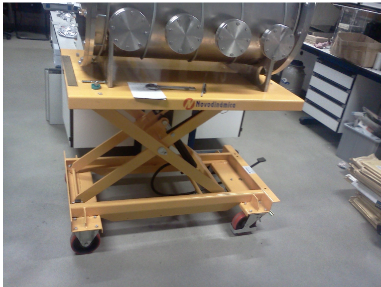
Figura 4.26: Mesa elevatória para movimentação da infra-estrutura de teste.
