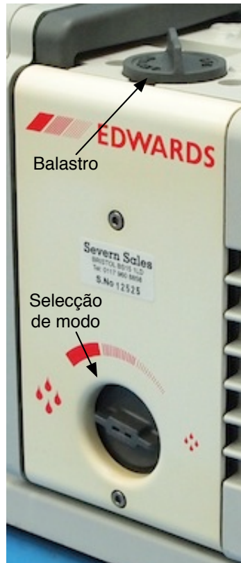
Figura 4.23: Botões ajustáveis para controlo do funcionamento da bomba rotatória.
