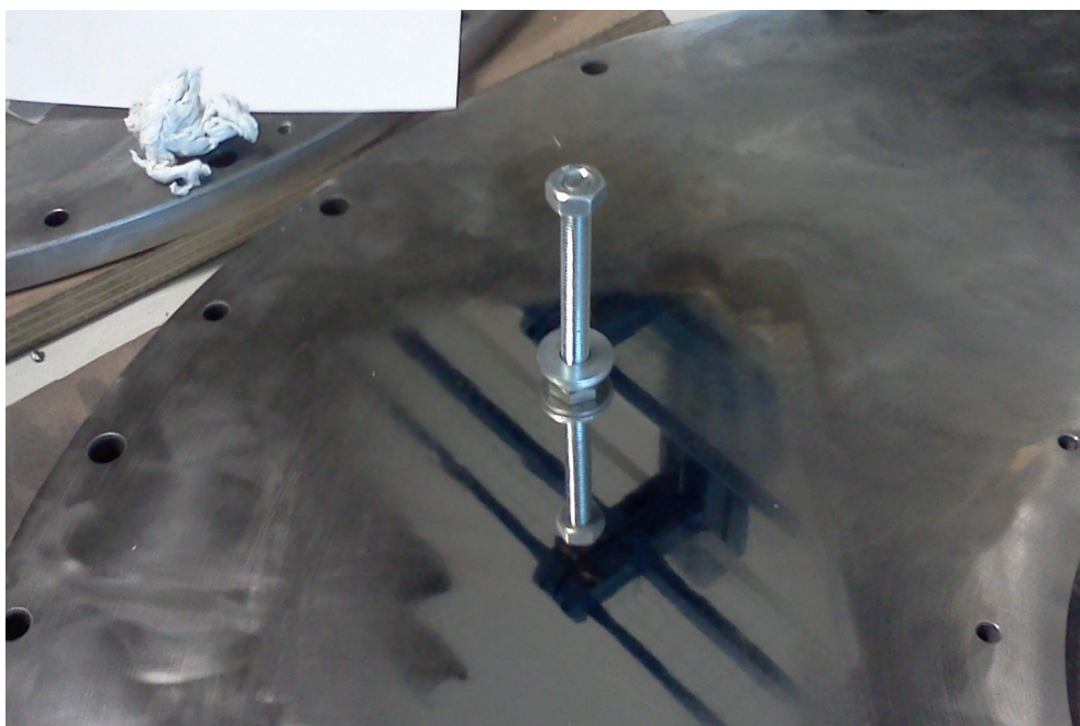
Figura 4.38: Polimento da superfície de uma das tampas da infra-estrutura de teste.
