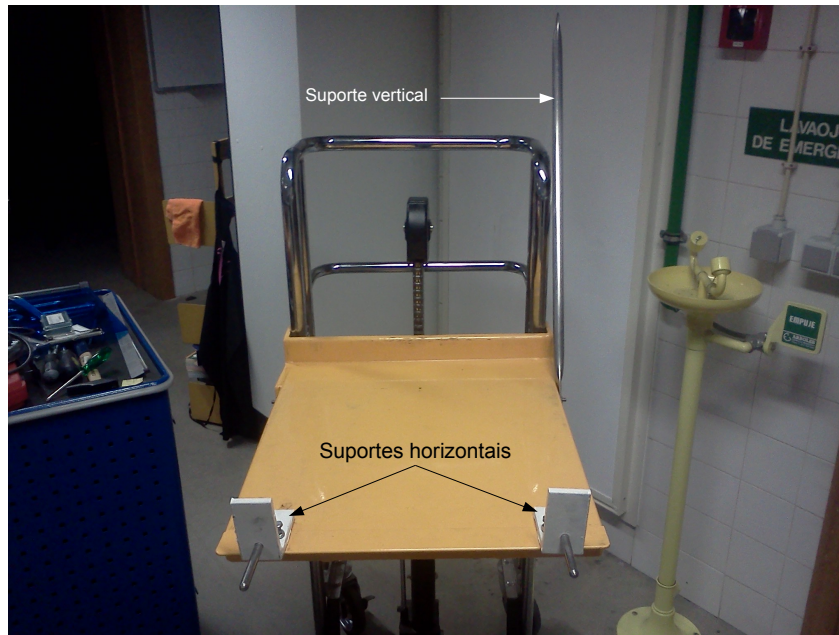
Figura 4.24: Porta-paletes ajustado para movimentação das tampas da infra-estrutura de teste.
