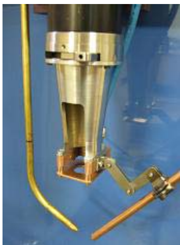
3. ábra – A lézersugaras hegesztőfej
