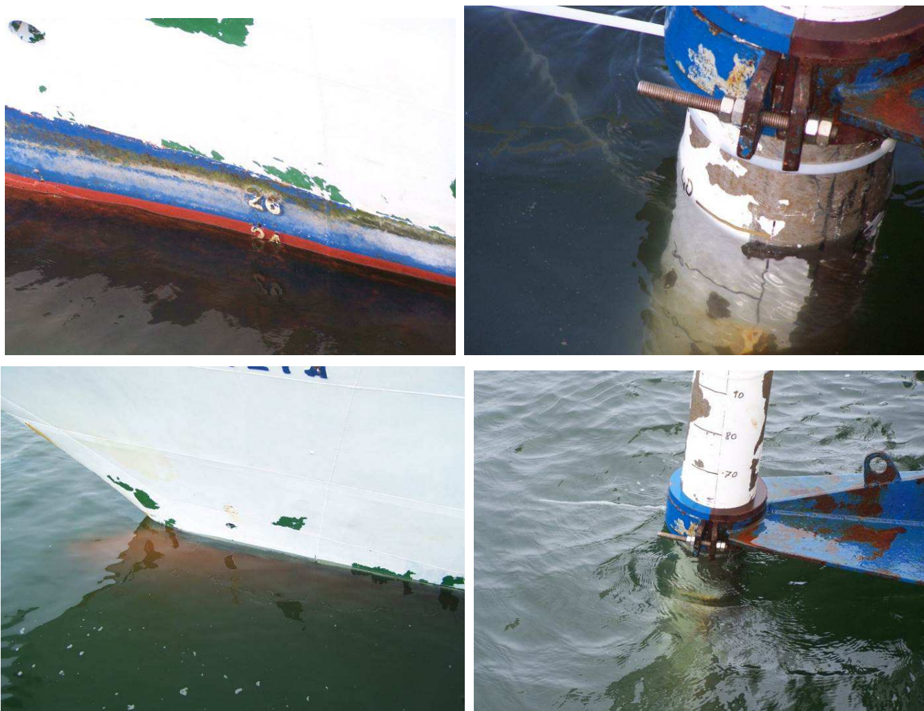
Fig. 14 – In alto è visibile l'assetto nella nave senza carburante, mentre in basso la nave a pieno carico. Si può notare anche la variazione di immersione del palo del multibeam.
