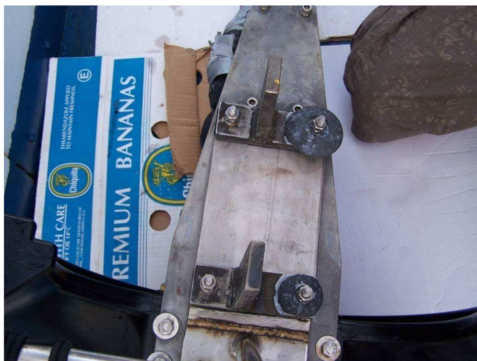
Fig.6 - Le nuove staffe in ferro realizzate per questa campagna; alla fine dei 25 giorni in acqua non presentavano nessun segno di usura.
