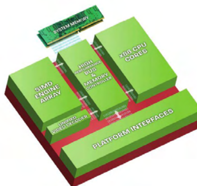
FIGURE 2.16 – Organisation d'un AMD Fusion APU
