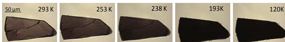
**Figure 3-43 :** Images en microscopie optique en transmission d'un monocristal de [Fe(meta'-Me<sub>2</sub>-(bapbpy))(NCS)<sub>2</sub>] lors du refroidissement. On observe la conversion graduelle et homogène de la phase haut spin vers la phase bas spin.
