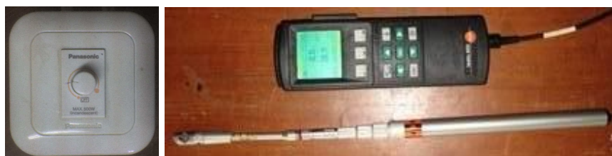
Gambar 3.4. Reostat (kiri), dan anemometer (kanan)
