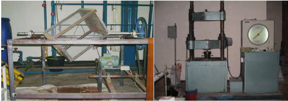
Gambar 3.5. Alat uji ketahanan standar ASAE S269.4 DEC 96 (kiri) dan UTM (kanan)
