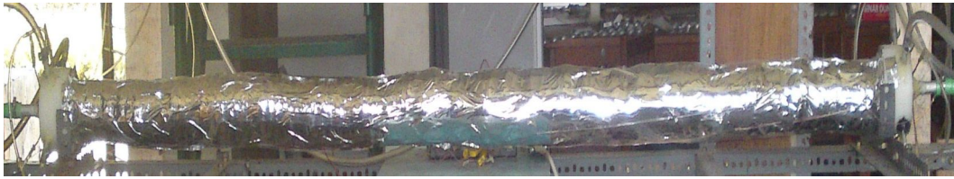
Gambar 3.2. Penukar kalor pipa konsentrik satu laluan
