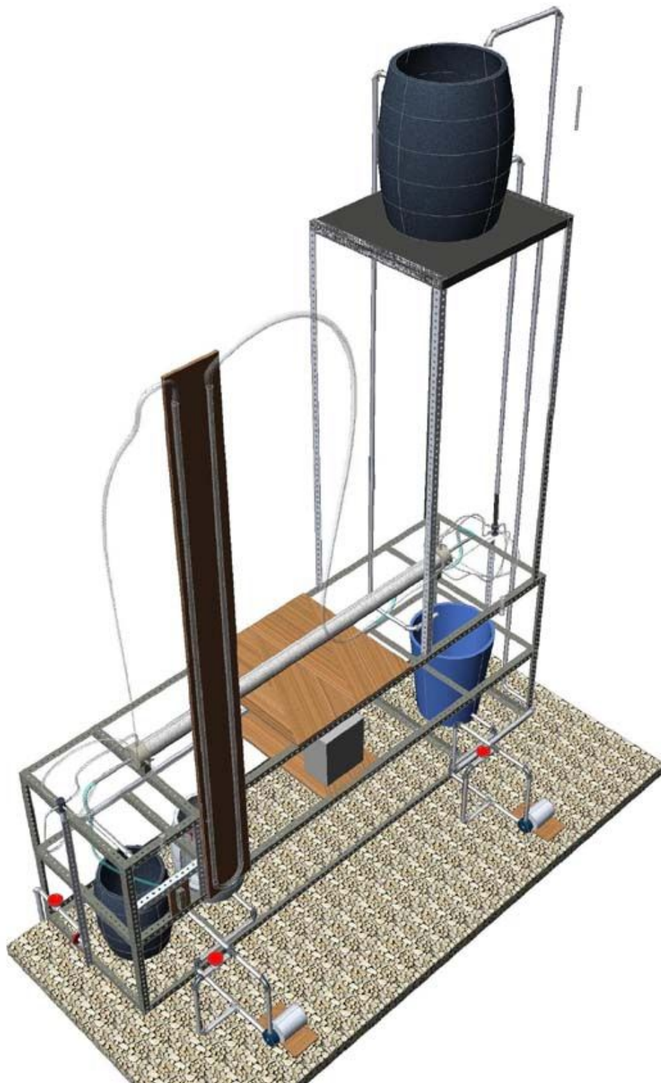
Gambar 3.12 Gambar 3D instalasi alat penelitian tampak atas
