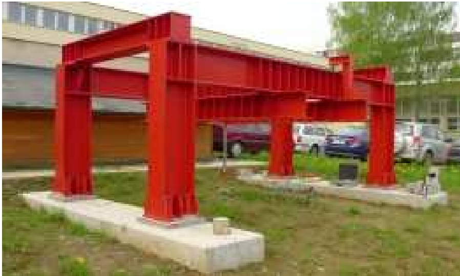
Obr. 2 Statická zatěžovací deska pro experimentální výzkumy (zdroj: http://www.mladiivyzkumnici.cz/cz/section/detail?section_id=4 )
