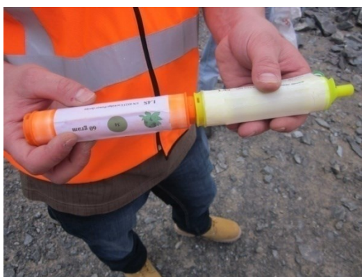
Obr. 19: Napojení zesilovací nábojky na iniciační [11].
