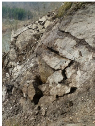
Obr. 27: Rozpukání skalního masívu [vlastní přínos]
