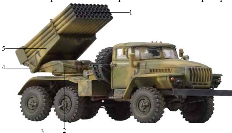
Рисунок 3.14 – Бойс БМ-21: 1 – пакет труб; 2 – основа; 3 – шасі; 4 – погон; 5 – люлька
