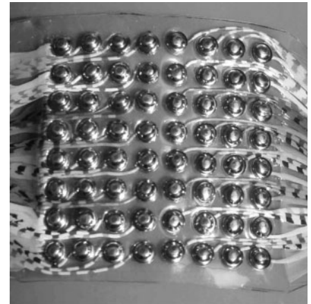
Abb. 4. Array mit 64 Kontaktelektroden und einem Abstand von 8 mm für Messungen an Extremitäten.
