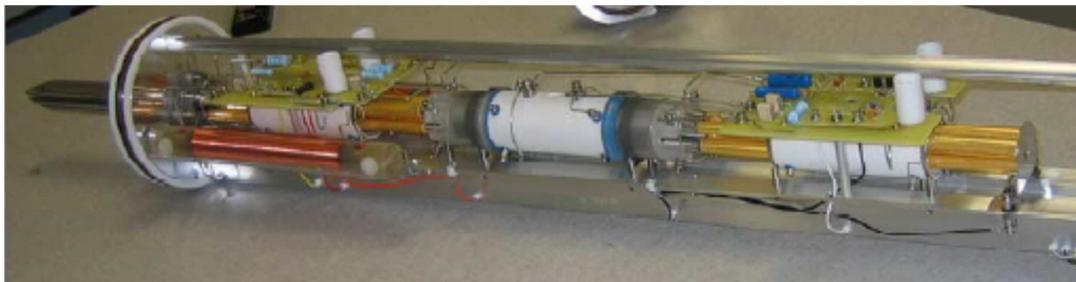
**Abbildung 8:** Triplequad MS – API 4000; (aus Trainingsunterlagen API 4000™ LC/MS/MS System, Applied Biosystems 2009)
