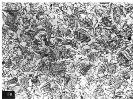
Fig. 3 : Microstructure de l'acier à souder après TTR, G = x500 (réd. 50%)
