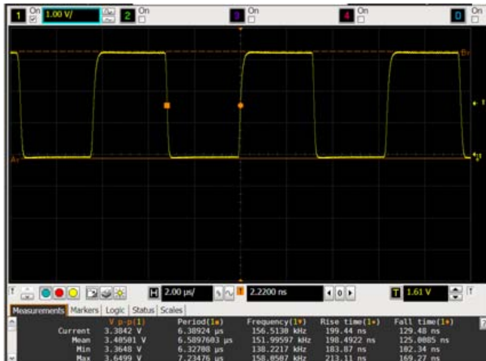
Figura 4.31: Resposta de sortida del convertidor CtoF de baix consum.
